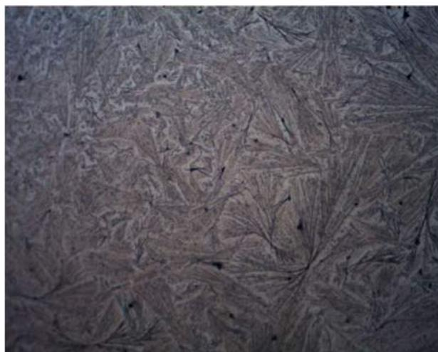
Figura 6 – Micrografia da superfície da amostra atacada com ácido oxálico
