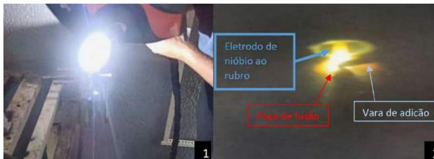
Figura 6. (1) abertura de arco foto sem filtro e (2) abertura de arco e poça com filtro de solda.
