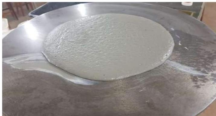
Figura 4 – Ensaio de espalhamento da mistura
