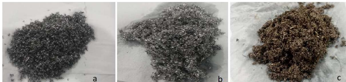
Figura 1- Cavacos de fresamento: a) do Aço ABNT 1045; do Alumínio; do Bronze TM23
