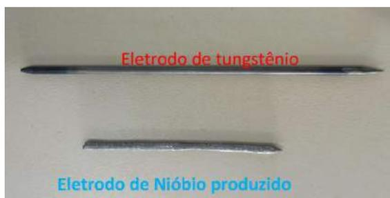
Figura 5 – Comparação entre os eletrodos.
